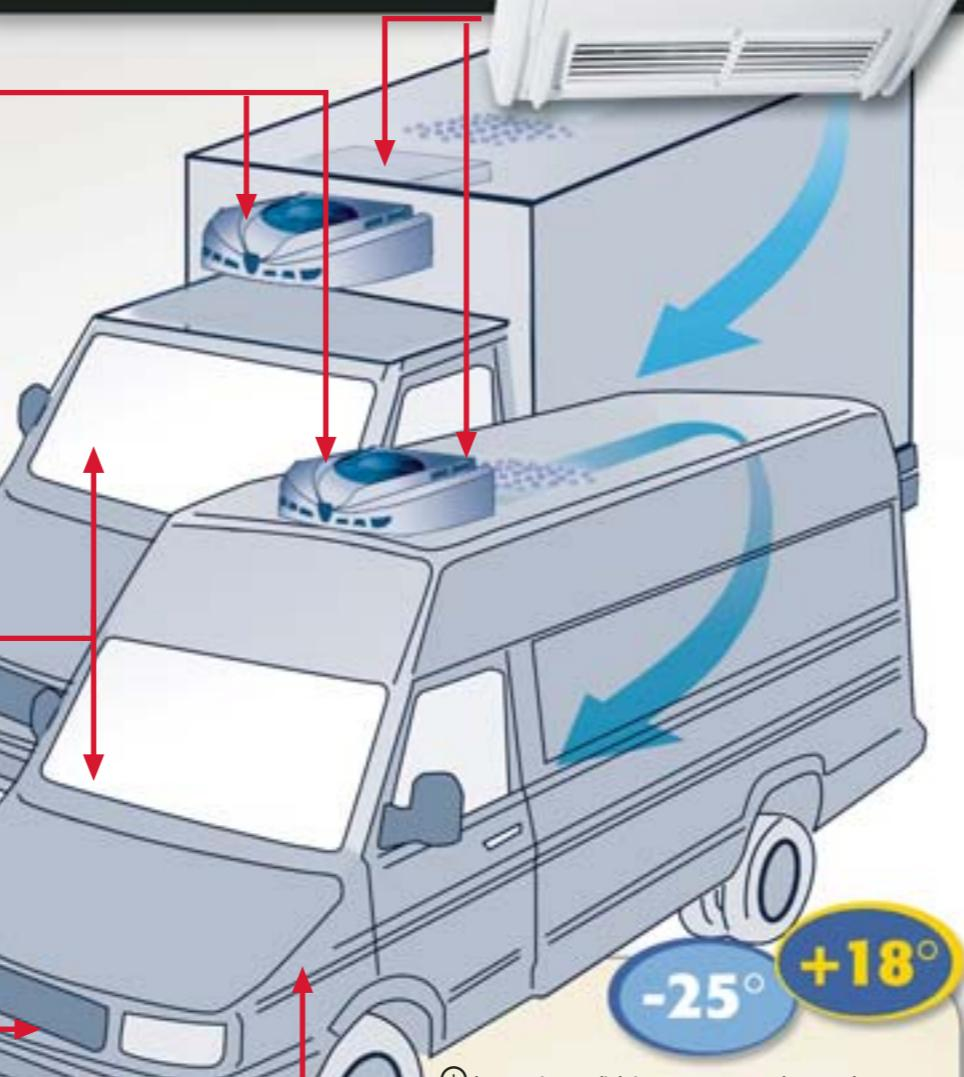
① Il nuovo sistema di sbrinamento permette lo scongelamento dell'evaporatore in tempi rapidissimi, minimizzando le pause di raffreddamento. Lo stesso concetto applicato al riscaldamento, permette di raggiungere la temperatura desiderata anche in ambienti molto freddi.
